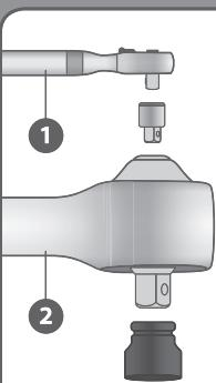
✉ K utahování či povolování šroubových spojů prostřednictvím násobiče momentu používejte momentový klíč z důvodu kontroly kroutícího momentu na vstupu. **Přetáženie násobiče jeho poškození.**
