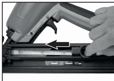
Obr. 11, nastavenie posúvania klincov
